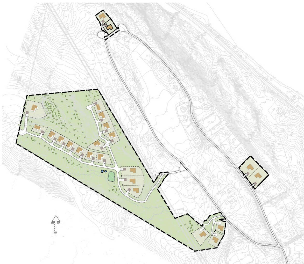
Figur 10. Illustrationsplan som redovisar planerad bebyggelse. Det är tomtplaceringar och GC-väg på plankartan som gäller.
