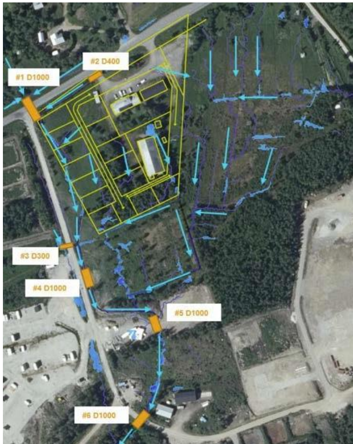
Fig 15. Avvattningen inom olika delområden. Gul markering avser aktuellt planområde. Mörkblå linjer avser modellerade befintliga rinnstråk. Ljusblå pilar avser flödesriktning. Orangea rektanglar trummor under vägar med numrering och diameter (mm) (Tyréns, 2022). En tidigare planskiss illustreras.
